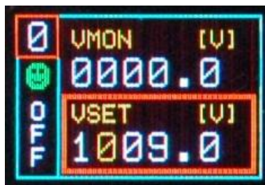
Fig. 4.12: Channel VSET digit access screen
