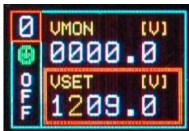
Fig. 4.13: Channel VSET digit adjust screen
