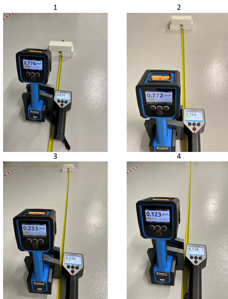
Fig. 4: RadHAND e DiscoverRAD durante la misura di una sorgente di ^{137}\text{Cs} di 8.91 \cdot 10^6 Bq di attività a (1) 50 cm, (2) 100 cm, (3) 200 cm, e (4) 300 cm.
