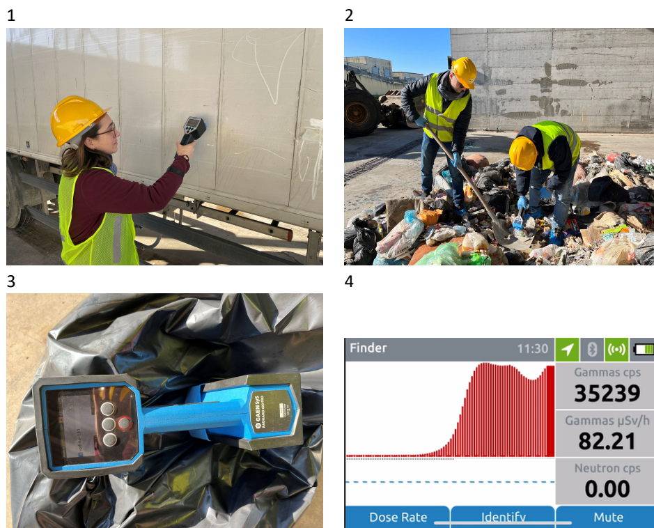
Fig. 1: (1) Localizzazione del rifiuto radioattivo sulla parete del camion; (2) Localizzazione del rifiuto radioattivo tra quello non radioattivo; (3) Identificazione della sorgente radiologica con RadHAND; (4) Aumento del rateo di conteggi registrato da DiscoverRAD quando posizionato vicino alla sorgente.
