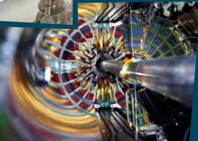
La partie centrale du détecteur de particule et le tube du LHC où a lieu la collision de protons.
